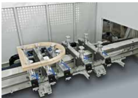
Rundbogenbearbeitung auf CNC-Konsolen
