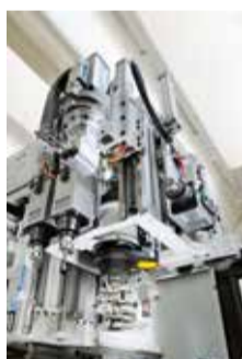
Agrégat de fraisage et perçage avec moteur principal
